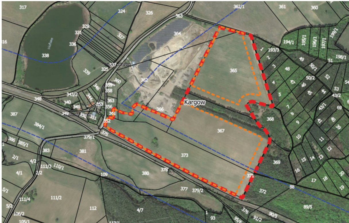
Abbildung 2 Detailliertere Ansicht der Potenzialflächen/ Modulbelegungsfläche (orange) sowie Darstellung des 200m Randstreifens zu Bahntrasse (blau) als auch der voraussichtliche gesamte B-Plan-Umfang (rot) (o. Maßstab)
