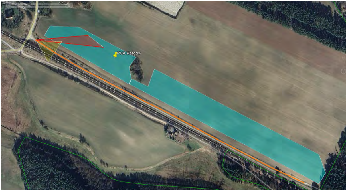
Abbildung 16: Relevanter Sichtwinkel der Verkehrsteilnehmer auf dem Fahrradweg in Gelb, Immissionswinkel in Rot, von potenzieller Blendung betroffenes Sichtfeld in Orange, betroffener Streckenabschnitt in Orange (Quelle: Google Earth, Airbus)
